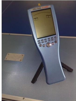
Εικόνα 3.1 –Αναλυτής φάσματος AARONIA Spectran HF-6080
