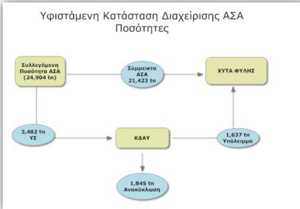
ΣΧΗΜΑ 7: ΥΦΙΣΤΑΜΕΝΗ ΚΑΤΑΣΤΑΣΗ ΔΙΑΧΕΙΡΙΣΗΣ ΑΣΑ - ΠΟΣΟΤΗΤΕΣ
